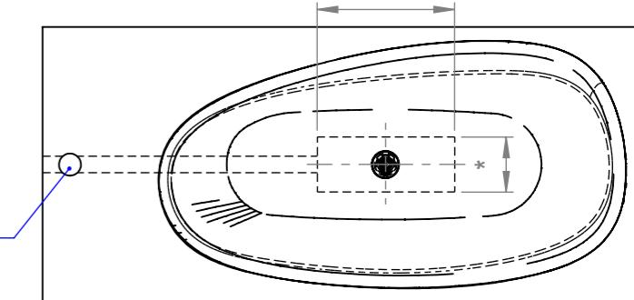
OPZIONE CON POZZETTO PER ISPEZIONE
